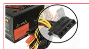
به کانکتور مادگی ۴ پین بزرگ برای تغذیه وصل کنید.
